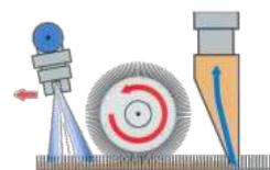
**Charis-ONE** è una macchina compatta, per la pulizia di aree di moquette di media dimensione. Con Charis-ONE è possibile pulire perfettamente una striscia di 40 cm di moquette, rimuovendo lo sporco fino alla base delle fibre. La portata dell'acqua spruzzata può essere regolata, per effettuare una **pulizia di manutenzione** a bassa umidità, oppure una **pulizia di fondo**.
