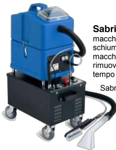
**Sabrina-Foam** è una macchina ad estrazione di schiuma con compressore interno. La macchina spruzza una speciale schiuma densa sulla superficie da pulire. La densità della schiuma può essere regolata. Sabrina-Foam può lavorare anche come una normale macchina a iniezione-estrazione. Il sistema di aspirazione ad alta depressione consente di rimuovere la massima quantità di sporco dalla moquette e dai tessuti imbottiti e di ottenere un tempo di asciugatura molto breve.
