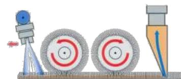
**Charis-DUAL** è una macchina compatta, per la pulizia di aree di moquette di media dimensione, con molte caratteristiche innovative. Con Charis-DUAL è possibile pulire perfettamente una striscia di 40 cm di moquette in una passata unica, grazie alle sue **2 spazzole controrotanti**, rimuovendo lo sporco fino alla base delle fibre della moquette. La portata dell'acqua spruzzata può essere regolata, per effettuare una **pulizia di manutenzione** a bassa umidità, oppure una **pulizia di fondo**.
