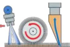
**Elite-Silent** è una lavamoquette-lavapavimenti compatta, a trazione manuale. Lava, spazzola ed asciuga una striscia di 50 cm di moquette, camminando in avanti e pulendo fino a **500mq** di moquette in un'ora.
